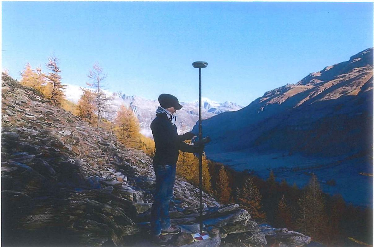
Abbildung 3: Einmessung der Passpunkte mittels Differential-GPS.
